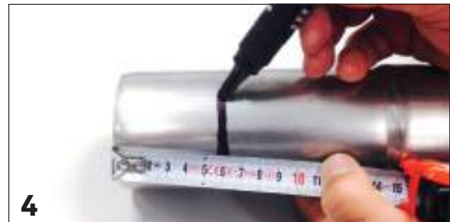
4 Marcatura quota d'innesto / Marking the insertion's depth
